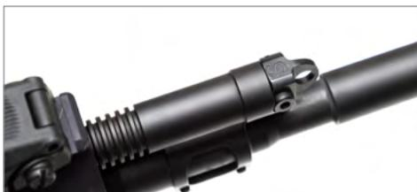
Встановіть перемикач на газовому блоці самозарядної зброї у положення ▷ для стрільби із саундмодератором
