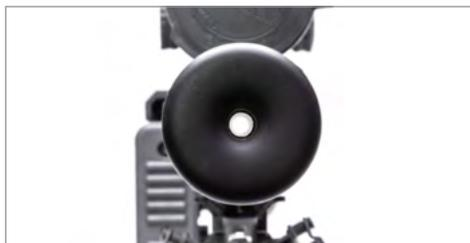
△ Після встановлення модератора проконтролюйте його співвісність із каналом ствола
